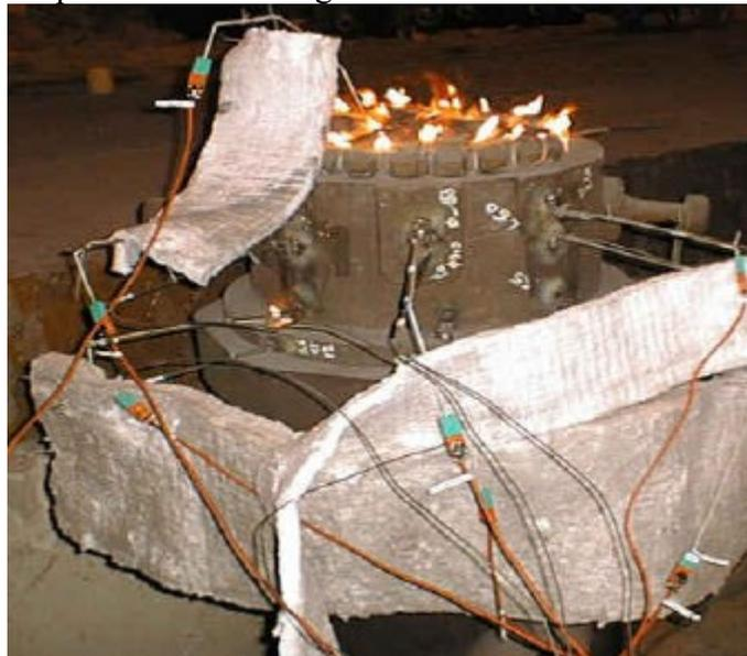
**Figure 1-4 : Détail de l’instrumentation du lingot O3t3 de Aubert et Duval [HANS, 2002]**
