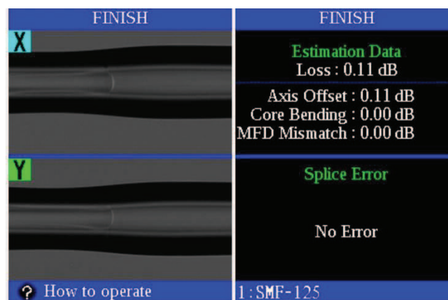
Figure III-27: Soudure d'une fibre vitrocéramique (gauche) sur une fibre standard SMF-28 (droite)
