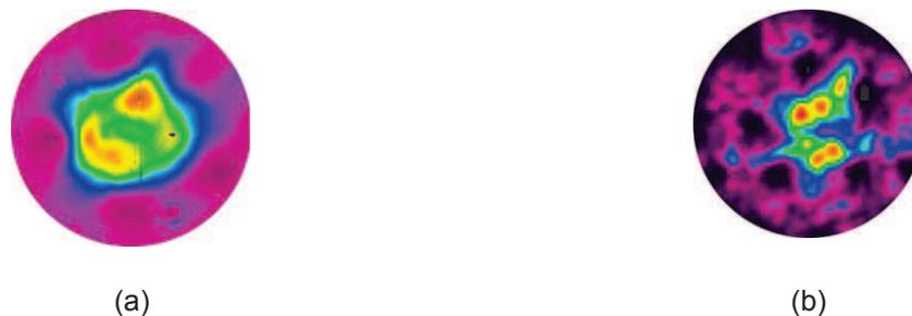
Figure 74 : Distribution d'intensité en mesurée en champ proche à la sortie d'une fibre FA-LPF à gaine réduite ayant un cœur de  $80\mu\text{m}$  en utilisant une source (a) supercontinuum et (b) à  $2\mu\text{m}$ .
