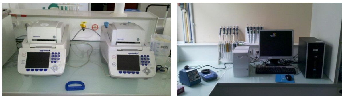
Figure I-11 : à gauche : Mastercycler epgradient S (Eppendorf) pour l'amplification de l'ADN par PCR, à droite : Bioanalyzer 2100 (Agilent) pour l'analyse des produits de PCR.
