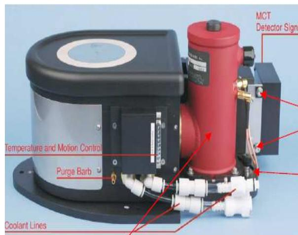
**Figure 23:** (a) Couplage rhéologie infrarouge Rheonaut (b) le système ATR monoréflexion (c) le détecteur MCT utilisé dans le cadre de cette étude.
