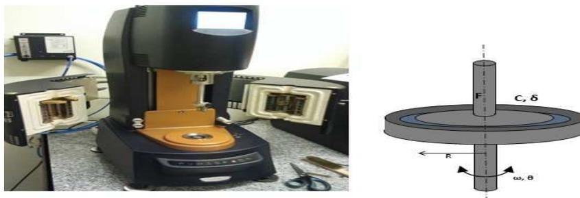
Figure 22: Rhéomètre à contrainte imposée DHR-2 de TA instruments avec la coupelle adaptée et conçue pour notre système réactif.
