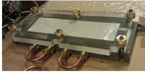
*Figure 27: Conception et réalisation du moule à deux épaisseurs pour la mise en forme. Moule instrumenté et thermorégulé*
