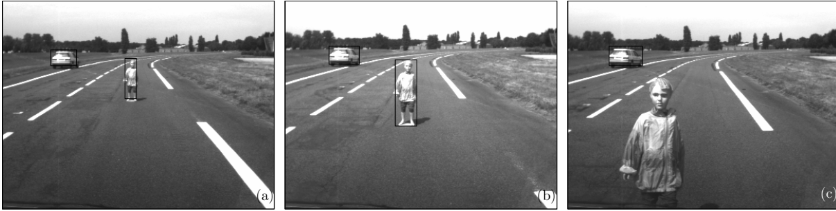
FIG. 3.32 – Exemples de cadres qui englobent deux objets de nature différente obtenus par l'utilisation conjointe des projections « v -disparité » et « u -disparité » de la carte de disparité quasi-dense. Sur (c), le piéton n'est pas détecté car il trop près du véhicule équipé.
