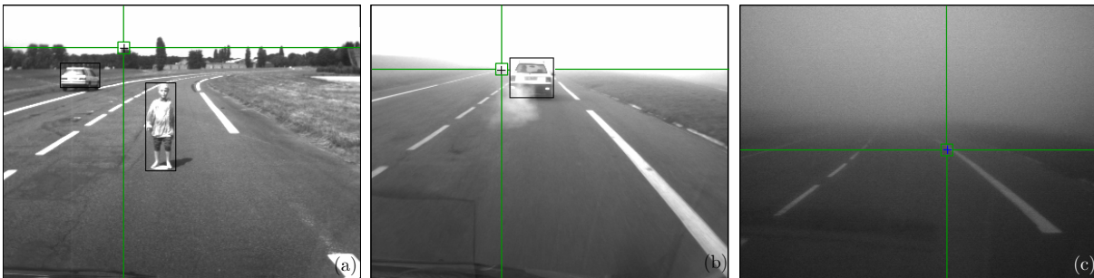
FIG. 3.33 – Mesure de la distance de visibilité mobilisée par l'approche 3-D généralisée. Outre la détection du masquage de l'infrastructure, la méthode développée recherche le voisinage le plus éloigné possédant un contraste supérieur à 5 %, représenté par une croix.
