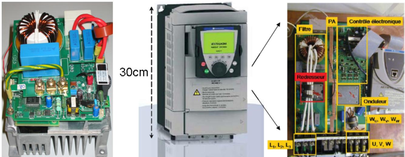
Figure I.1 – Variateurs de vitesse industriels (Schneider-Electric)
