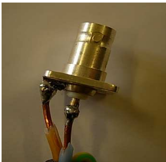
Figure 46. Câble soudé au connecteur BNC
