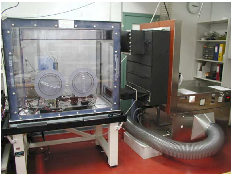
2.36 - Vue d'ensemble de la plateforme finlandaise de micro-assemblage et son environnement contrôlé en température et humidité
