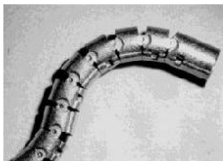
2.6 - Sonde d'endoscopie - diam. ext. 2,8 mm - [Oga98]
