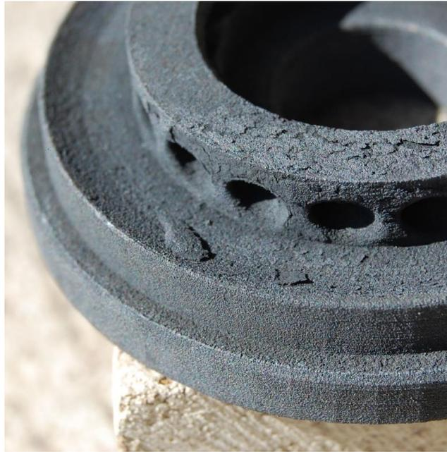
**Figure 104 : Photographie du distributeur après 48h à 1150°C.**
