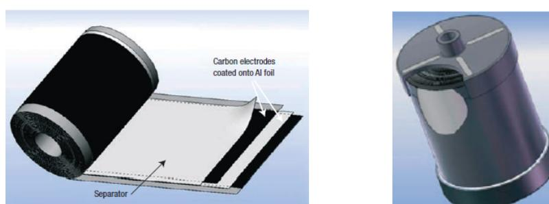
**Figure 3.** Vue éclatée (gauche) et bobinée (droite) d'un supercondensateur.<sup>6</sup>
