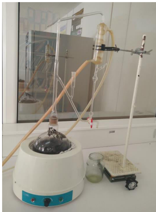
Photo 5 : Dispositif d'hydrodistillation de type Clevenger
