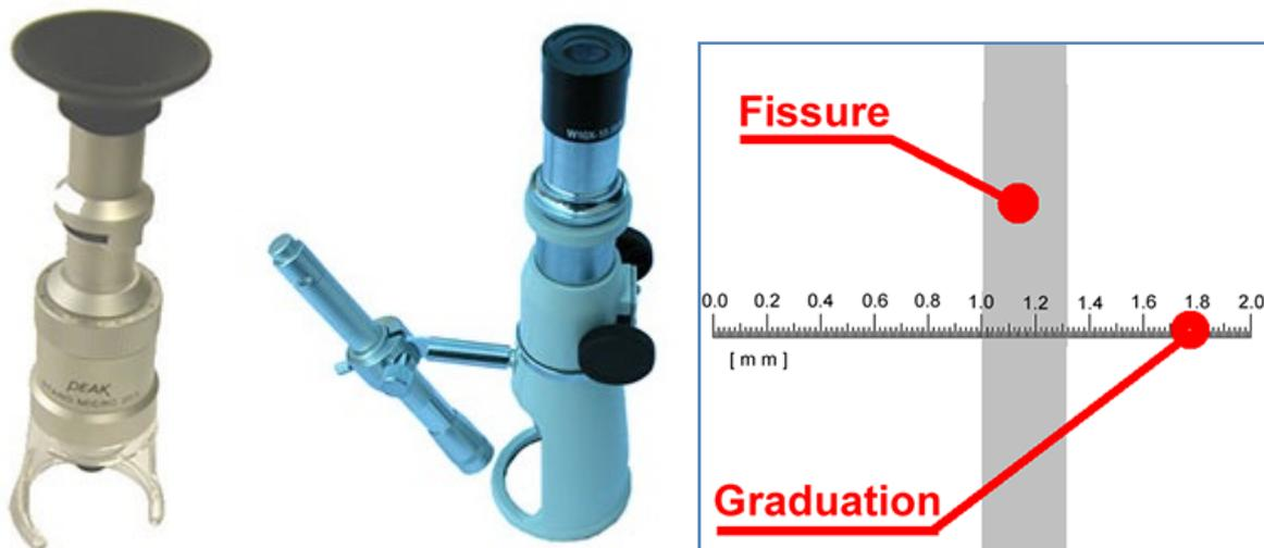
Figure II. 7. Lunette micrométrique pour mesure de largeur de fissure
