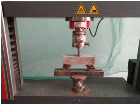
Figure II. 5. Essai de traction par flexion sur mortier
