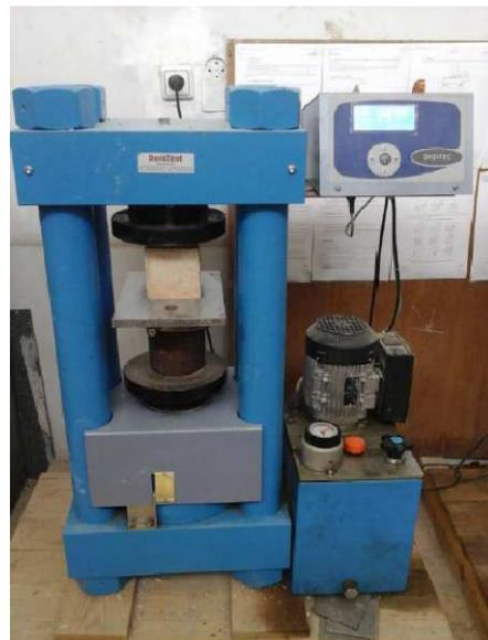
Figure II. 9. Essai de compression sur les bétons
