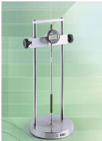
Figure II. 3. Dispositif avec comparateur pour la mesure de la longueur des éprouvettes
