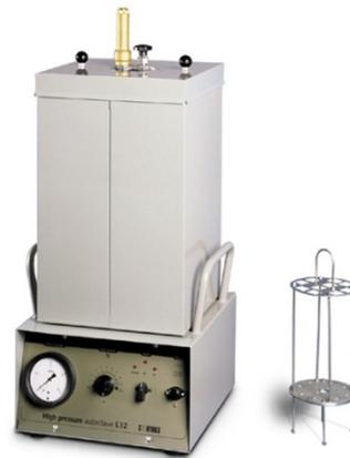
Figure II. 4. Autoclave (XP P 18-594).
