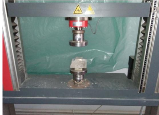
Figure II. 6. Essai de compression sur mortier
