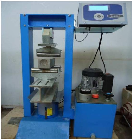
Figure II. 8. Essai de traction par flexion sur les bétons
