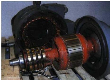
Fig.III. 4. Machine asynchrone à rotor bobiné (standard). [AGU10]
