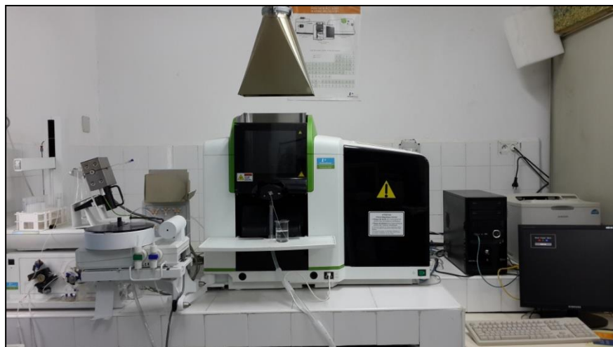
Figure 19 : Spectrophotomètre d'absorption atomique en type Perkin Elmer (PinAAcle 900T, USA).
