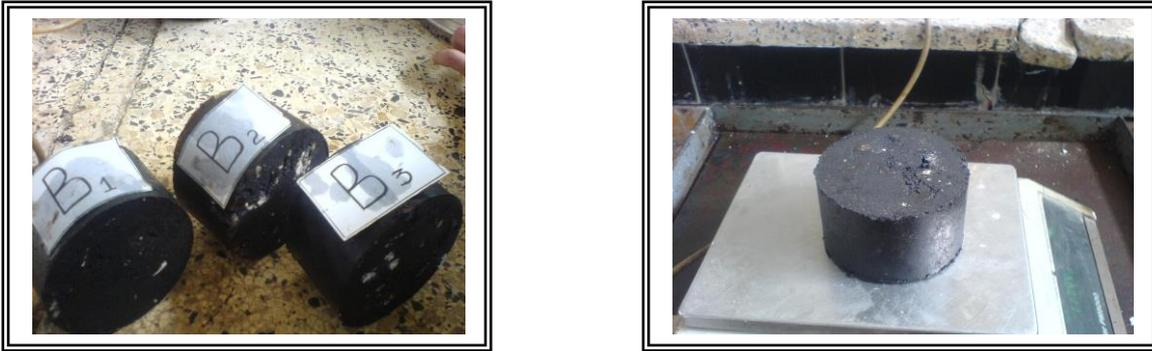
Figure 5.13 : Mesure des éprouvettes
