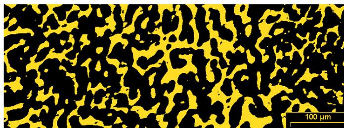
Figure 7.5 : Microstructure d'un bitume plastomère à matrice mixte
