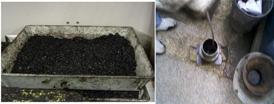
Figure 5.10 Préparation et remplissage des moules
