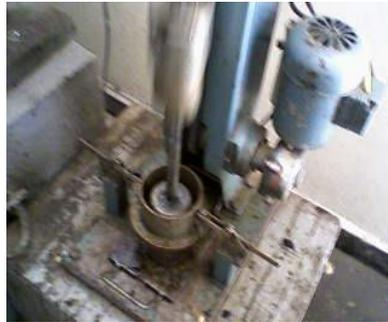
Figure 5.11 : Compactage des éprouvettes
