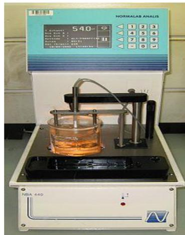
Figure 5.2 : Appareil de l'essai « Bille et anneau »
