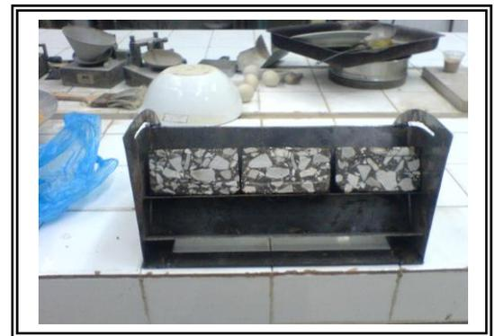
Figure 5.18: Des éprouvettes placées dans l'étuve
