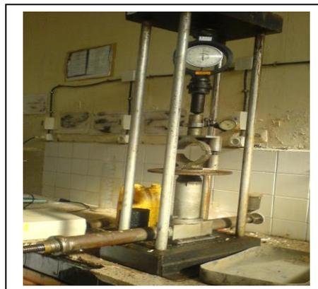
Figure 5.3 : Appareil de Marshall
