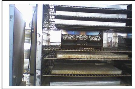
Figure 6.20: Des éprouvettes placées dans l'étuve
