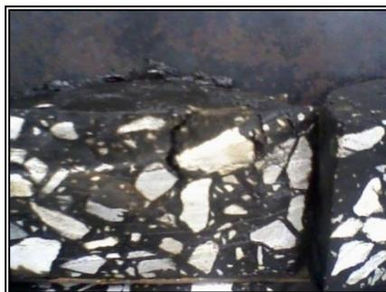
Figure 6.22: Des éprouvettes déformées (filler 15%)
