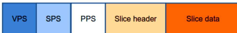
Figure II.18 Structure d'un bitstream HEVC
