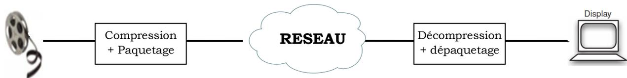
Figure V.2 Un système de communication vidéo simplifié
