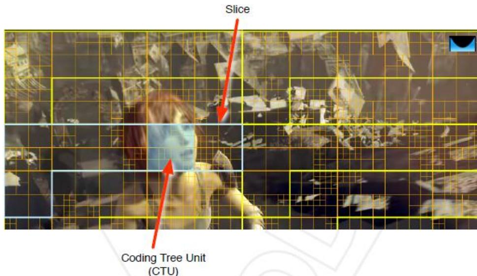
Figure II.8 Slice et CTU d'une trame vidéo (source Parabola research).
