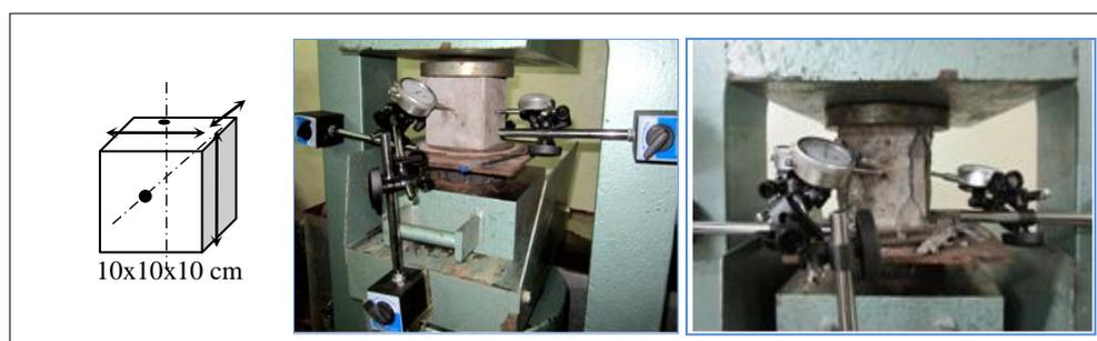
Figure II.4 Essai de compression des cubes de 10cm (NF P 18-406/ CSA A23.2-9C).
