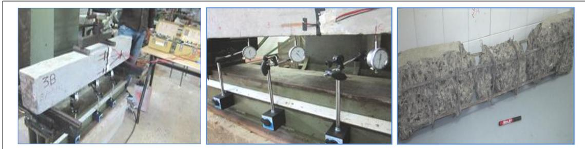
Figure II.6 Essai de flexion par quatre points, mesure de la déformée et de la flèche pour les poutres 120 × 20 × 15 cm selon AFNOR, ACNOR et ASTM.
