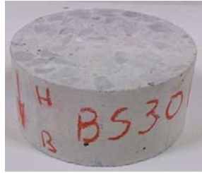
Figure 9.7 Photographie d'un échantillon de béton destinée pour la mesure de la perméabilité au gaz
