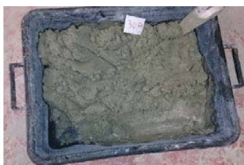
d- Mortier à base de 30% de RSB + 1% SP (M30A)
