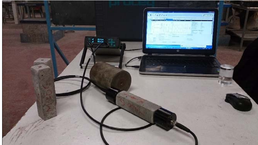
Figure 5.4 Photo de mesure du temps d'une onde dans une éprouvette de mortier
