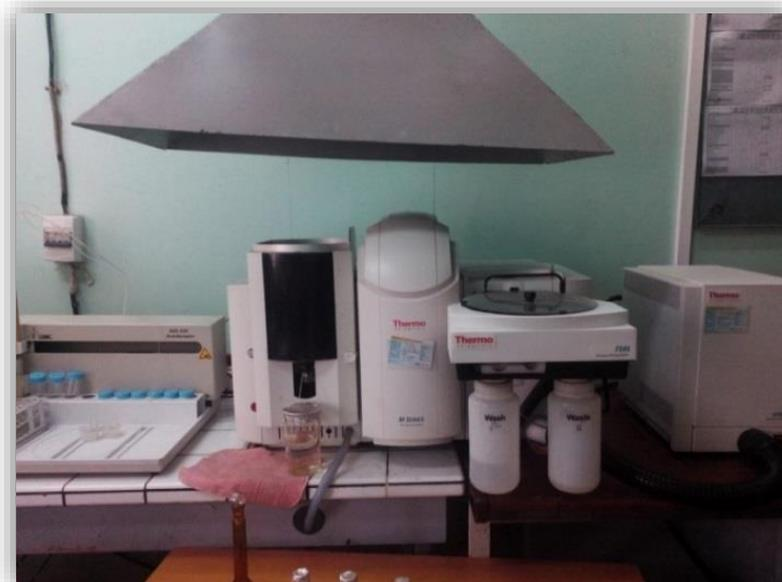
**Figure 8. Spectrophotomètre d'absorption atomique (ASX-520 Auto Sampler)**
