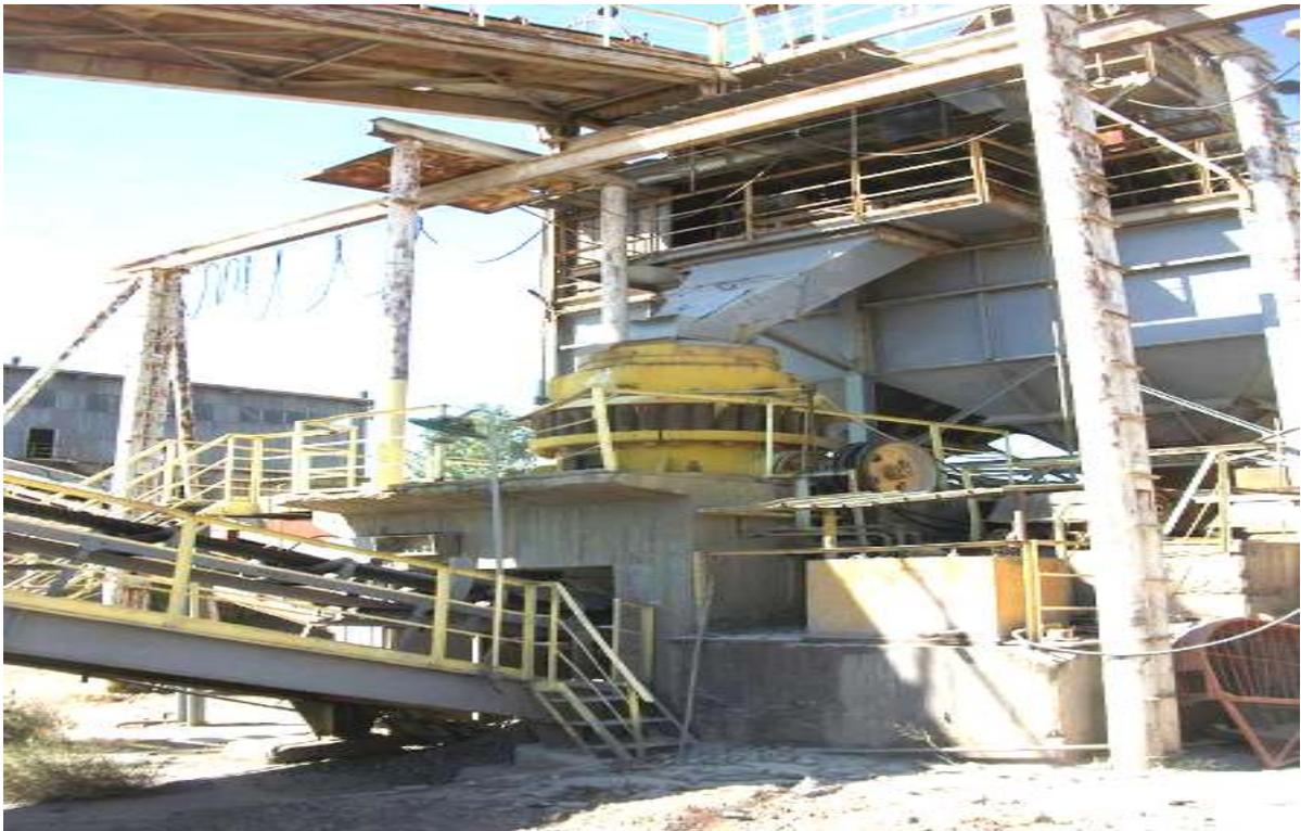
Figure 9. Conasseur à cône
