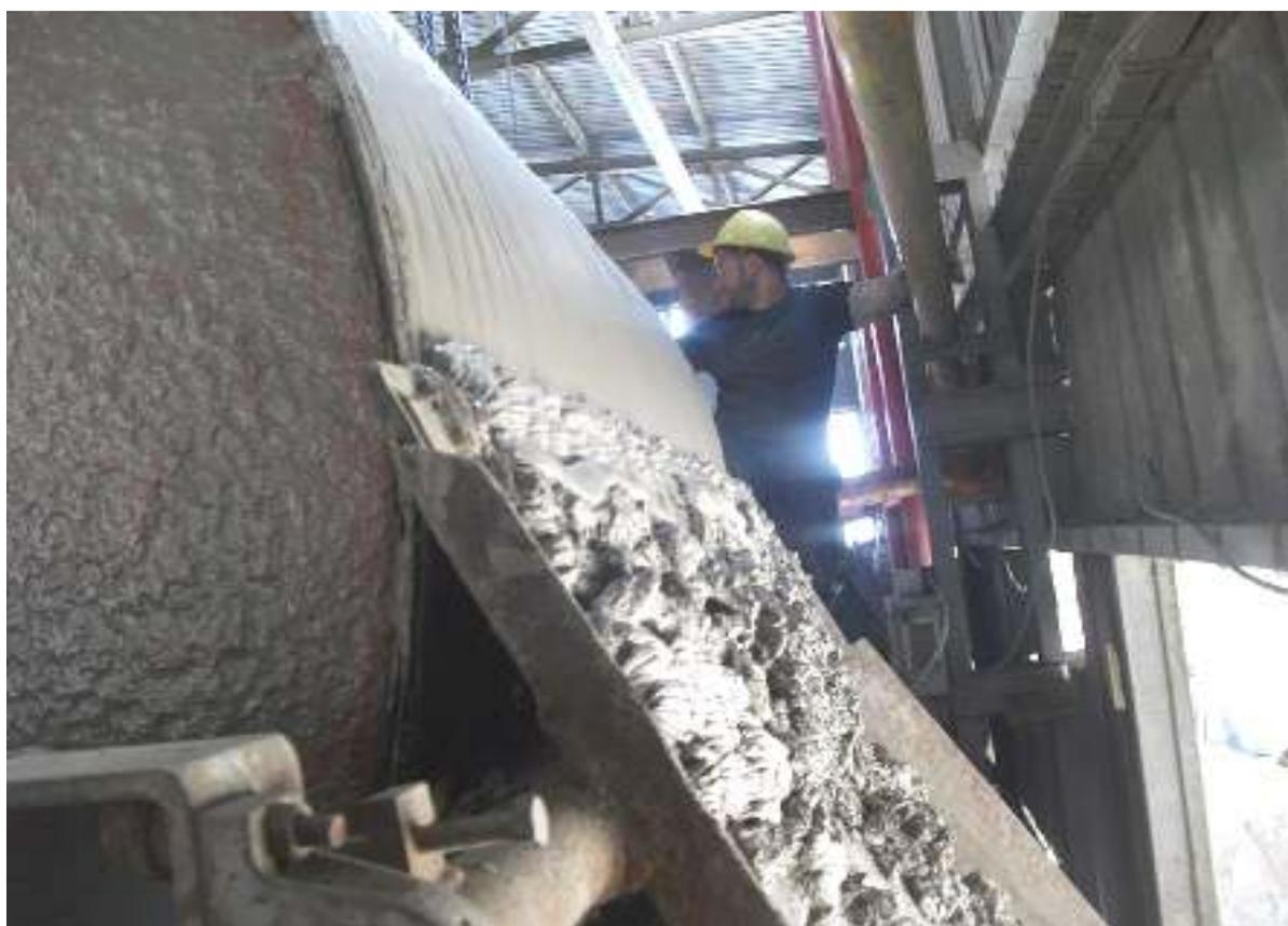
Figure 16. Filtration de concentré de flottation de blende ZnS
