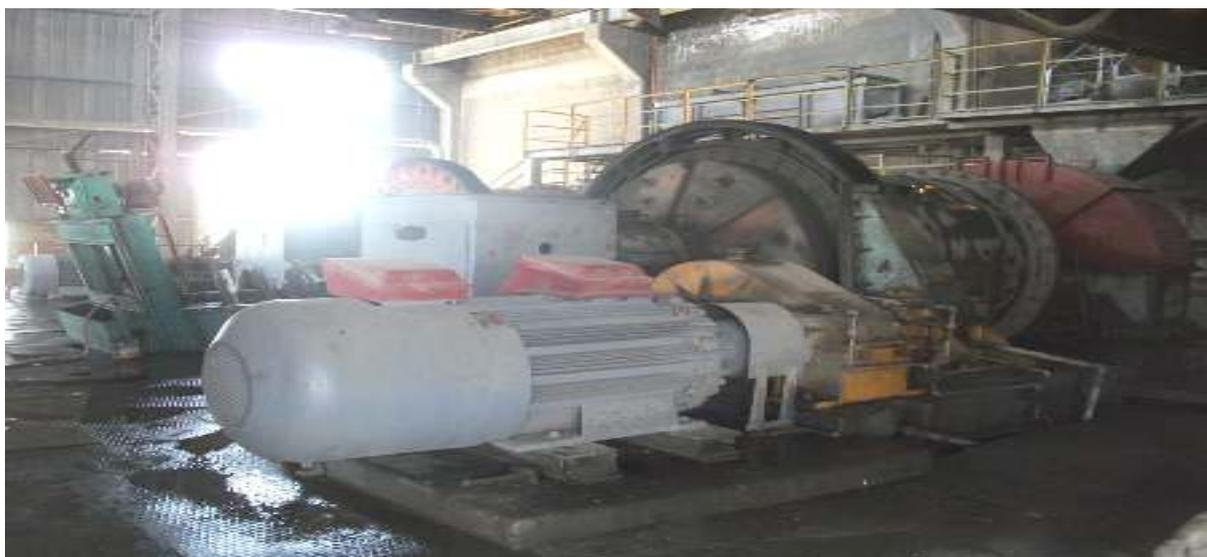
Figure 11. Broyeur à boulets
