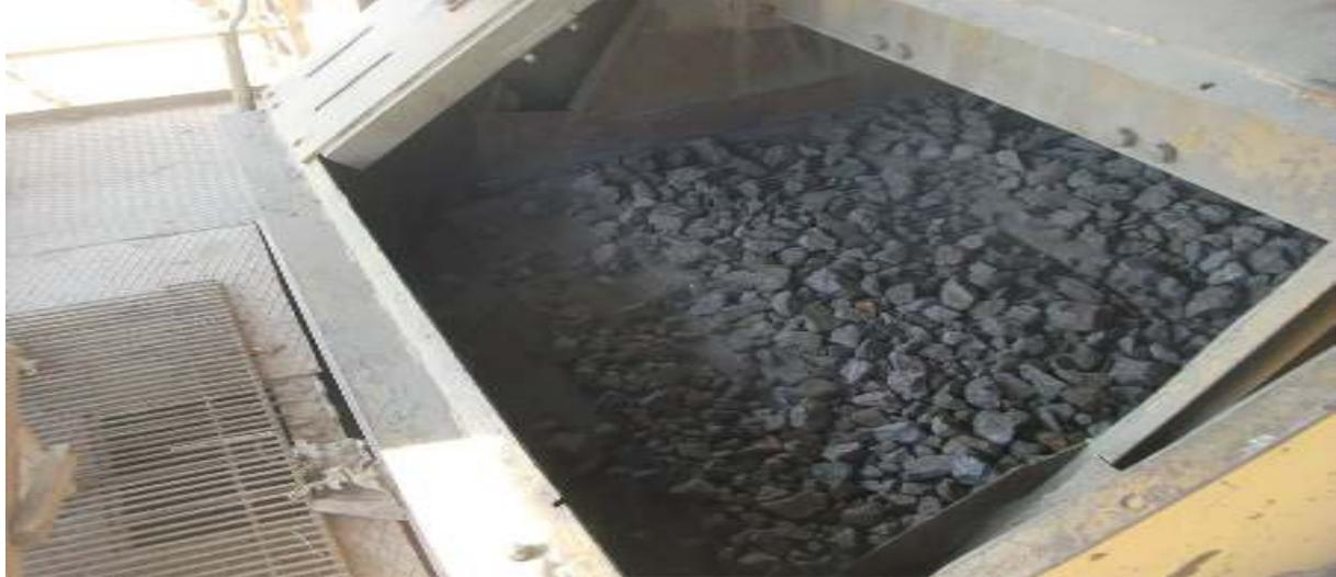
Figure 10. Crible vibrant
