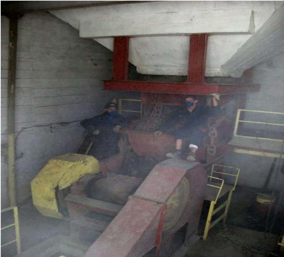
Figure 8. Conasseur à mâchoires à simple effet
