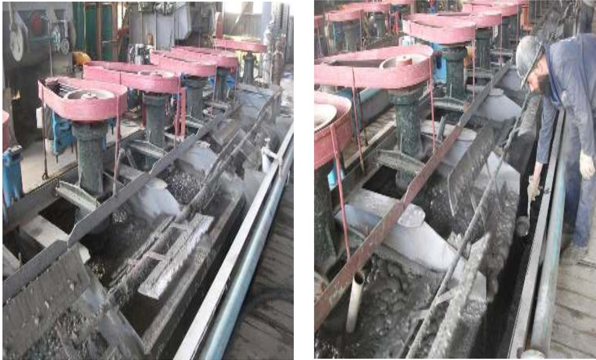
Figure 14. Cellule de flottation type Denver
