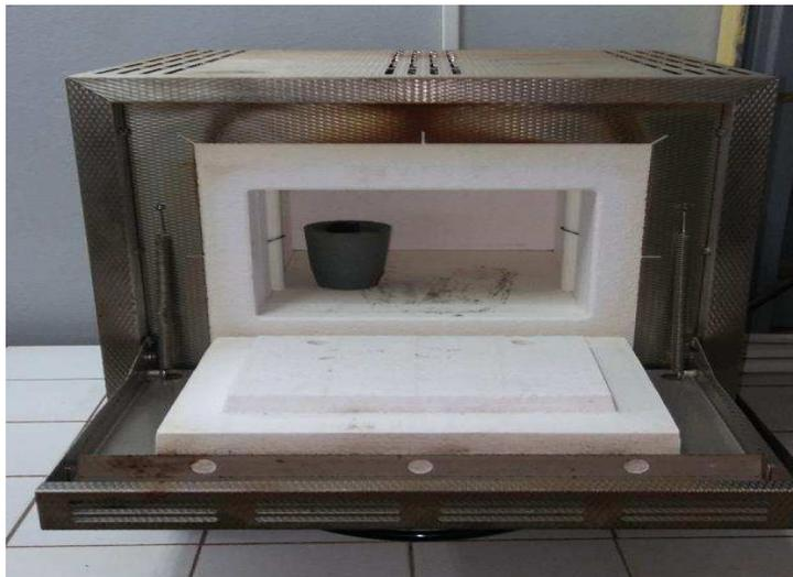
Figure IV.7 Four de laboratoire Naberterm température maximale 1100°C
