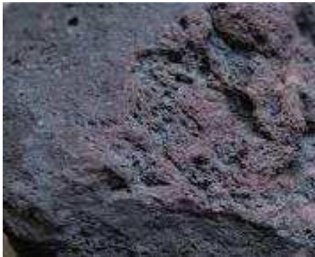
**Figure I.5** Minerai de magnétite
