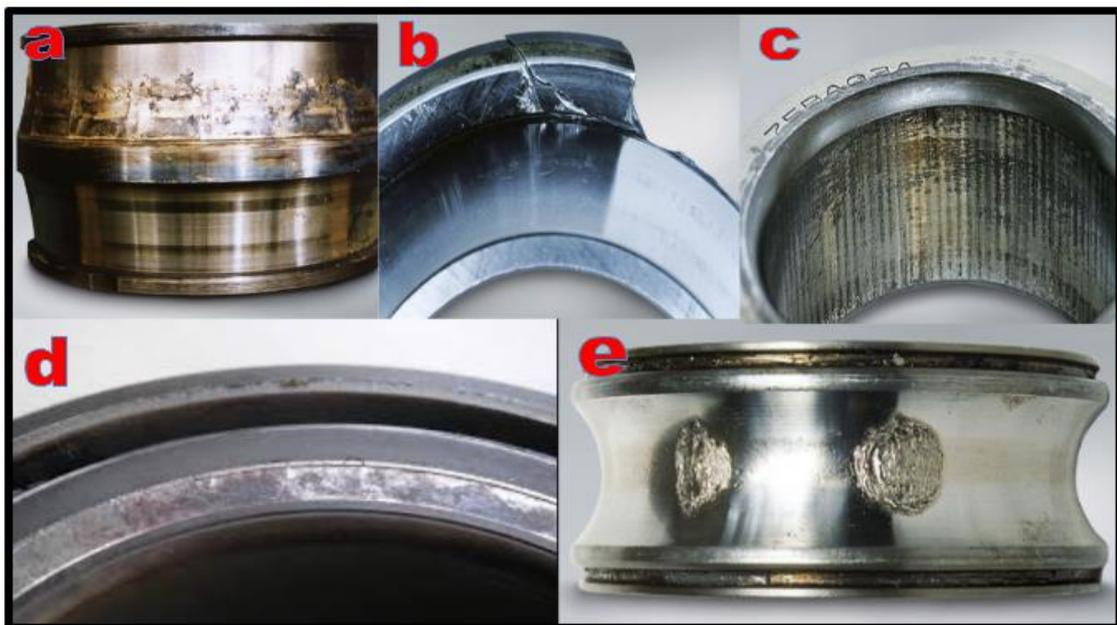
**Figure I.3** Exemples de défaillances affectant les roulements ; *a*: grippage, *b*: fracture, *c*: usure de contact, *d*: corrosion de contact, *e*: écaillage de la bague interne.
