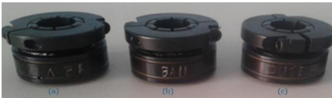
**Figure IV.3** Roulements défectueux utilisés dans notre travail : (a)- Défaut de la cage interne « IRF », (b)- Défaut de la bille « BAF », (c)- Défaut de la cage externe « ORF ».
