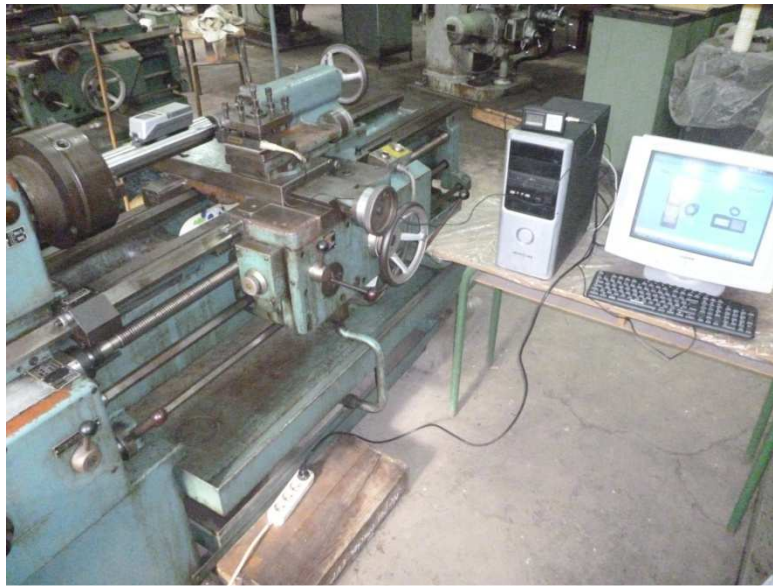
Figure 19 : Montage d'usinage, mesure de la rugosité et des vibrations
