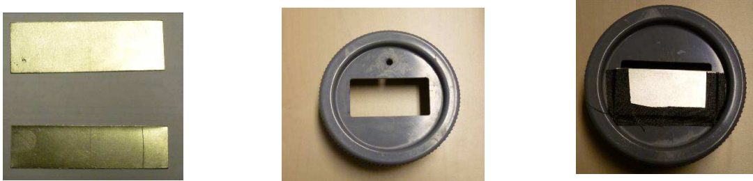
Figure 4.12 : Photographie des plaques en acier, bouchon avec trou et bouchon avec une légère ouverture obtenue à l'aide des plaques en acier.
