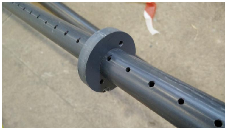
Figure 3.26. Tuyau perforé (25 mm de diamètre) prévu pour être encastré dans le tuyau de 63 mm de diamètre
