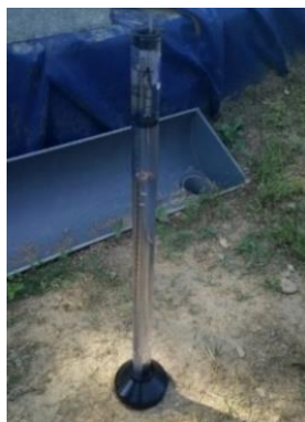
Figure 3.12. Essai d'infiltrométrie pour caractériser les propriétés hydrodynamiques (dont la conductivité hydraulique à saturation K_s ) de la partie centrale de la noue standard (infiltromètre à disque)
