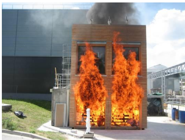
Figure 1.3-4: Photographie prise pendant un essai LEPiR 2 réalisé au CSTB
