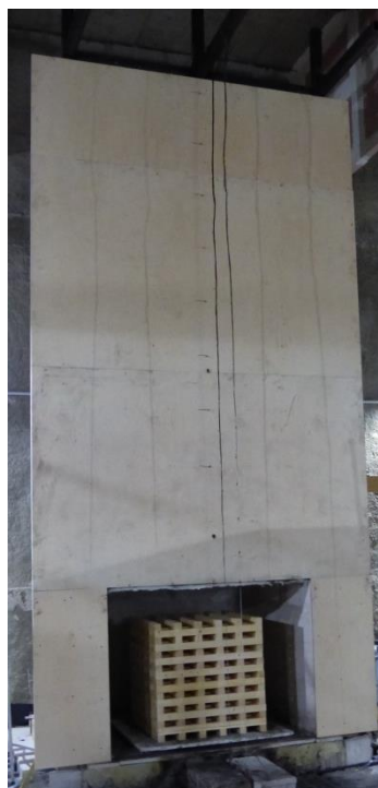
Figure 4.1-2 : Photographie du montage avant essai – Façade combustible
