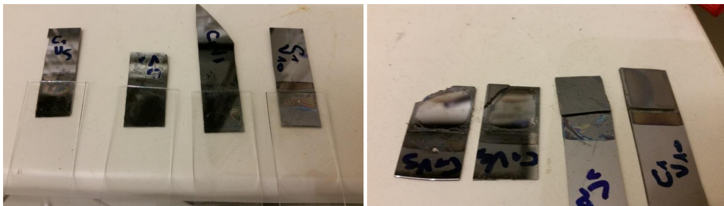
Figure 3.7 : Photos des assemblages silicium/verre à gauche qui sont collés puis silicium/silicium à droite dont certains se sont décollés. Des films de silice condensée sont déposés préalablement sur tous les wafers de silicium présentés
