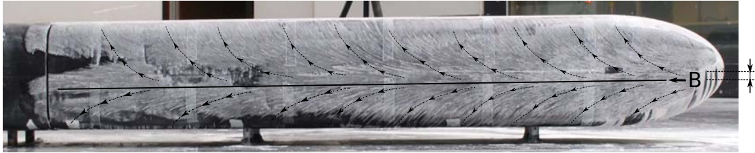
FIGURE 3.18 – Spectre pariétal sur la face au vent du modèle idéalisé à l'échelle du 15^e , \beta = 30^\circ .
