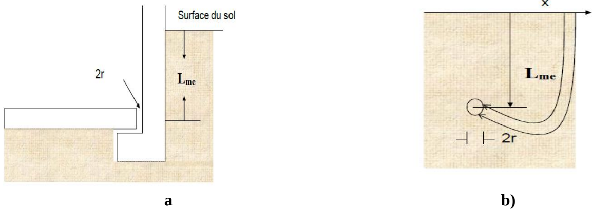
Figure 1.13 : Entrée d'air du sol vers le soubassement a) joint plancher-mur ; b) cylindre enterré avec un axe horizontal (Nazaroff, 1988 ; Abdelouhab, 2011).
