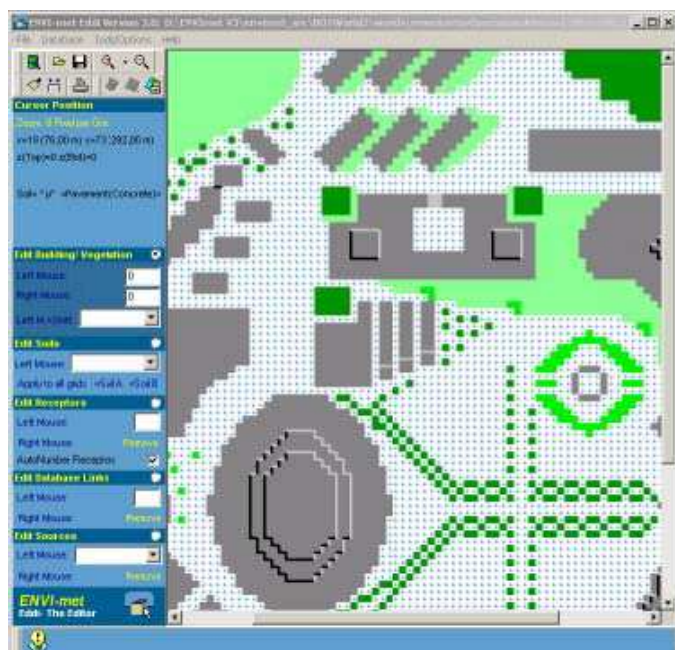
Figure 41 : Un exemple de l'éditeur utilisé pour créer les fichiers nécessaires à la simulation pour ENVI-met (Bruse, 2004).
