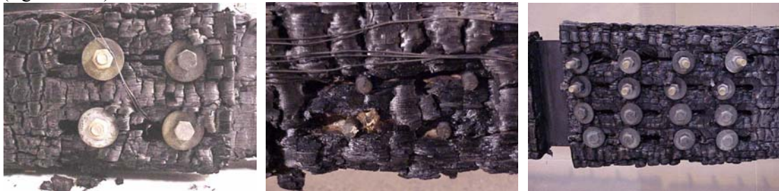
Figure A.38 : Rupture par cisaillement le long des files d'organes
