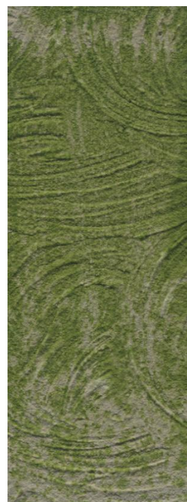
Figure 6.1 Evolution de la surface colonisée par les algues des mortiers carbonatés, de rapport E/C égal à 1, de rugosités R1 et R3 (essai n°4)
