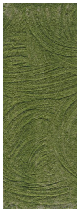
Figure 6.1 Evolution de la surface colonisée par les algues des mortiers carbonatés, de rapport E/C égal à 1, de rugosités R1 et R3 (essai n°4)
