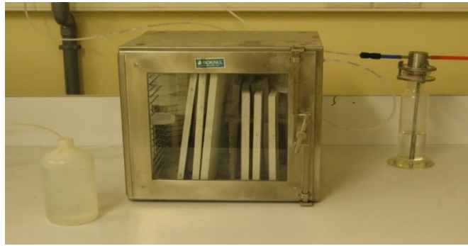
Figure 4.5 Montage expérimental de l'essai de carbonatation accélérée
