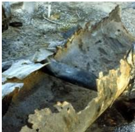
Figure 1.7 Tuyau d'égout détérioré suite à l'activité bactérienne
