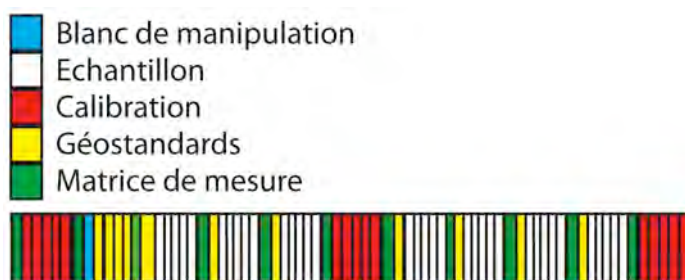
Figure II.23 : Schéma de séquence de mesure par ICP-MS. Les blocs rouges correspondent aux solutions de calibration, le carré bleu au blanc de manipulation, les verts à la matrice de mesure (2% \text{HNO}_3 ), les jaunes aux géostandards, et les blancs aux échantillons.
