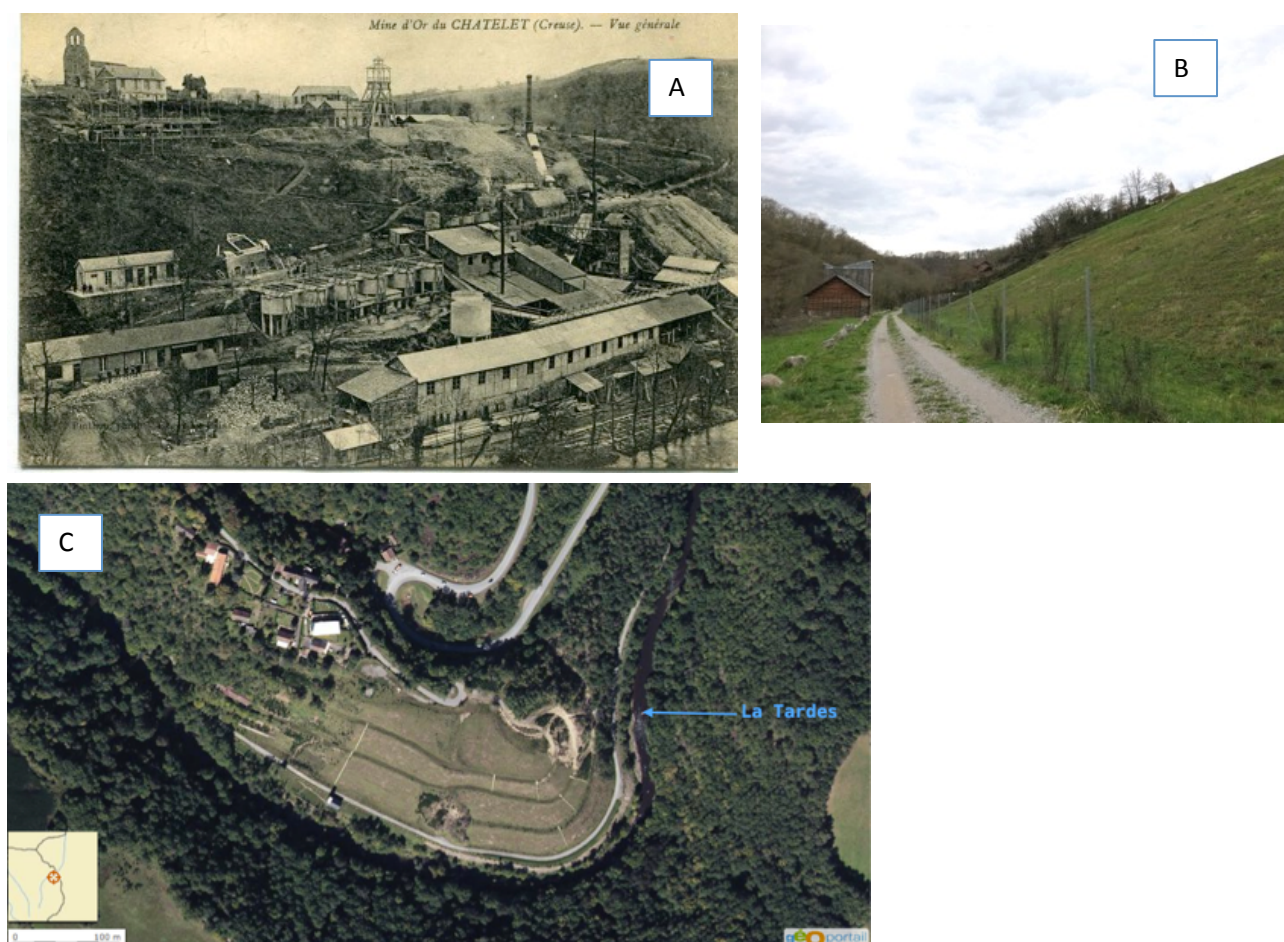
Figure II-14: Mine d'or du Châtelet (commune de Budelière). A) Carte postale: vue générale de la mine avec les cuves à cyanuration et le bâtiment central dans lequel était placé le four. B) Photographie des résidus miniers confinés et revégétalisés. C) Photographie aérienne du site réhabilité, clôturé et revégétalisé (Géoportail).
