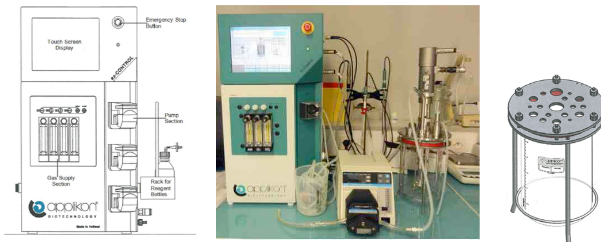
Figure III-5 : Système de Bioréacteur Applikon (cuve, couvercle, système d'agitation, ez-Control).
