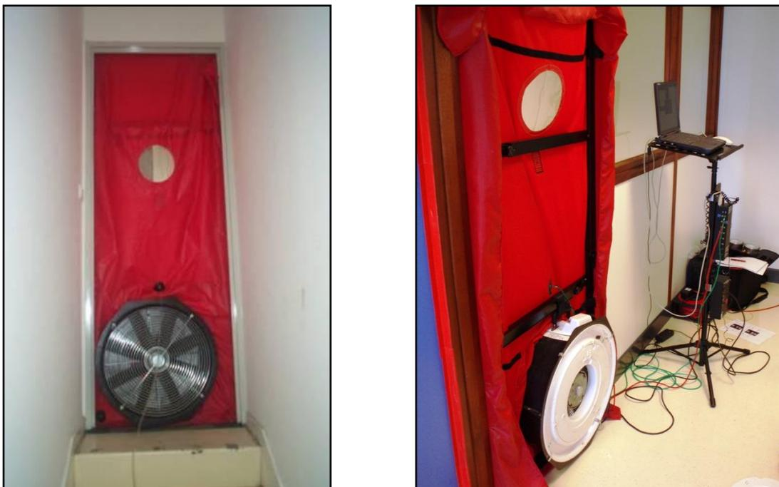
Figure 2.11 : Dispositif de mesure de la perméabilité à l'air.
