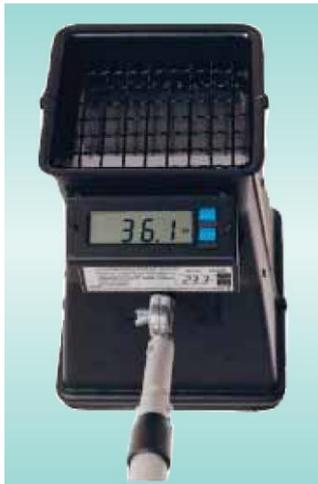
Figure 2.15 : Le Swemaflow® 233 utilisé pour la mesure des débits aux bouches.
