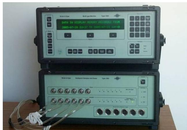
Figure 2.14 : L'échantillonneur et l'analyseur.
