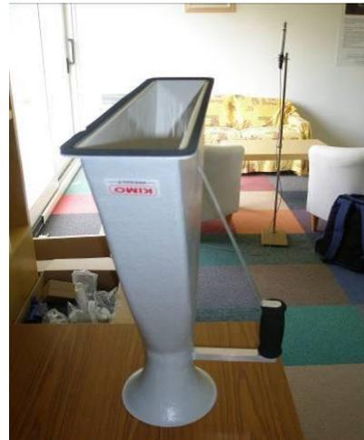
Figure 2.16 : Le cône de mesure de débits aux entrées d'air.
