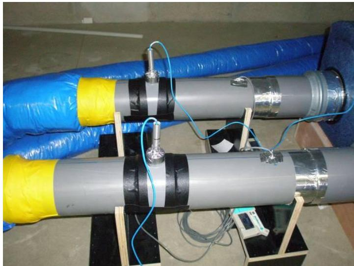
Figure 2.17 : Mesure de vitesse et de température d'air dans les gaines principales de la VMC double flux.
