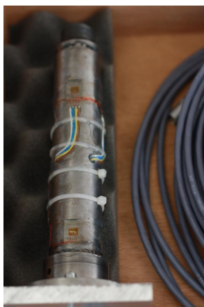
Figure 3.17 – Barreau instrumenté et jauges de déformation
