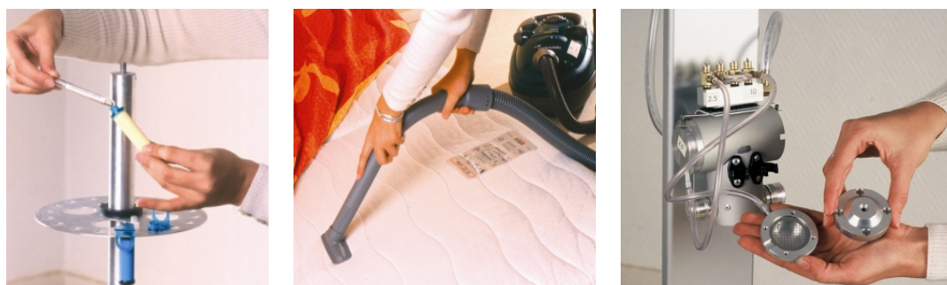
(a) Support adsorbant solide (b) Prélèvement par aspiration (c) Appareils de prélèvement des utilisé pour les prélèvements des acariens sur un matelas particules de COV et aldéhydes
