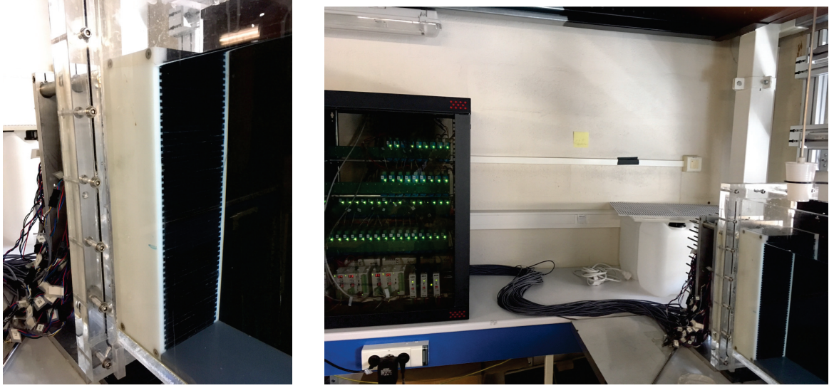
Figure 1.16: À gauche, le générateur GOAL dans une cuve d'expérimentation. À droite, une vue plus large du dispositif, avec l'armoire qui contient les automates et les contrôleurs des moteurs.
