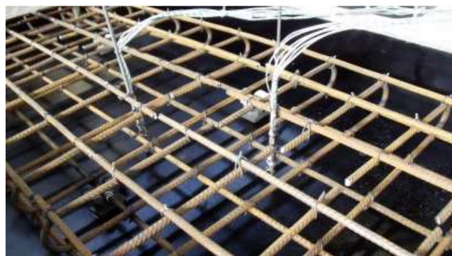
Figure 7.7. Implantation de deux échelles de thermocouples à boule dans le ferrillage
