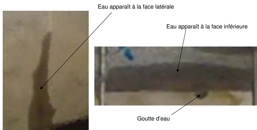
Figure 5.17 — Apparition de l'eau à une face latérale et puis à la face inférieure au cours de l'essai.
