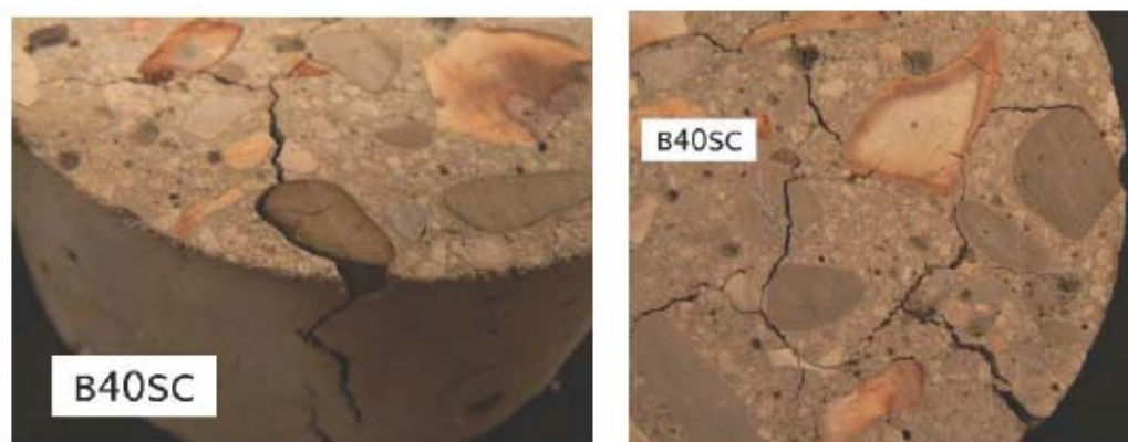
Figure 1.28 — Observation visuelle de l'éprouvette B40SC après traitement thermique à 400^{\circ}\text{C} : forte localisation de fissures autour des silex [96].
