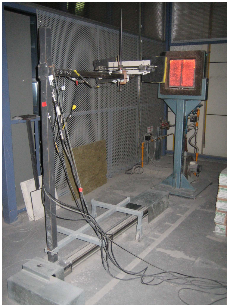
FIG. 3.1 – Banc de charge thermique
