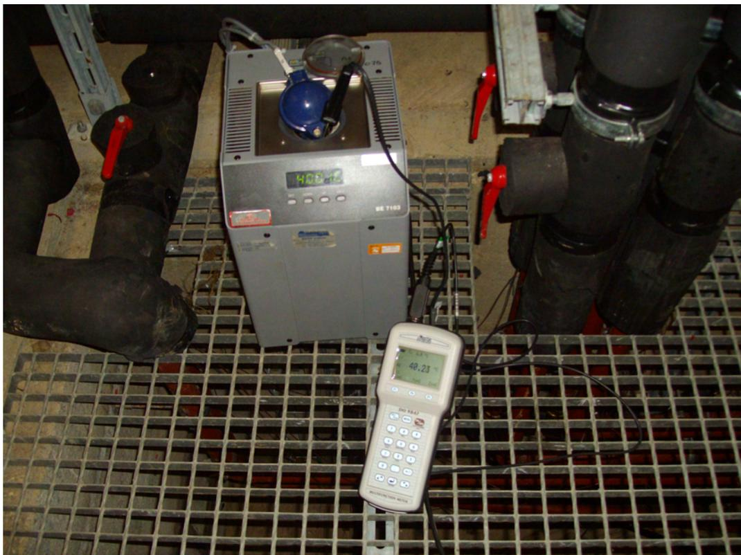
FIGURE 3.22 – Montage expérimental d'étalonnage des sondes de température Pt100
