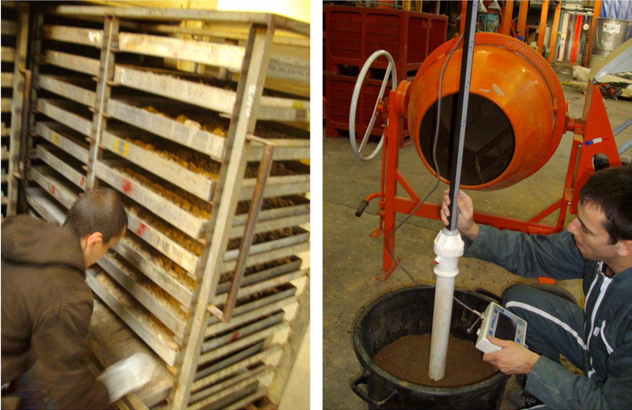
FIGURE 3.29 – Mise en place du sol sur les étagères de l'étuve et mesure de fréquence sur l'échantillon de sol
