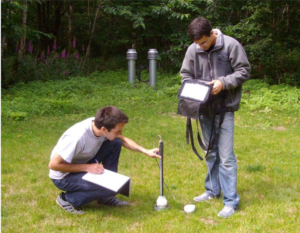
FIGURE 3.20 – Mesure du profil d'humidité du sol à l'aide de la sonde capacitive sur le secteur "pelouse ombragée"
