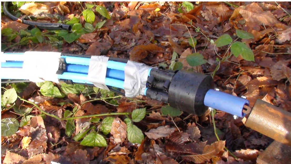
FIGURE 3.19 – Vue du pied de la sonde coaxiale équipée de sa fibre optique de mesure
