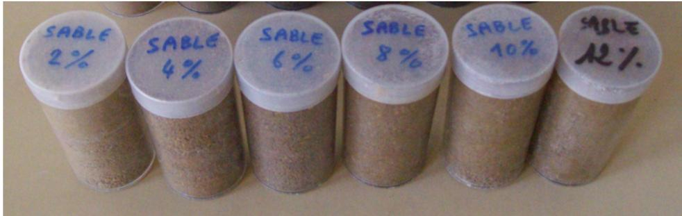
FIGURE 4.2 – Échantillons de sable de la plate-forme expérimentale conditionnés à différentes teneurs en eau avant mesure des propriétés thermiques
