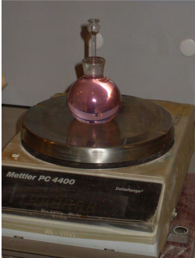
FIGURE 4.6 – Mesure de la masse volumique du mélange par pesée du pycnomètre rempli de fluide
