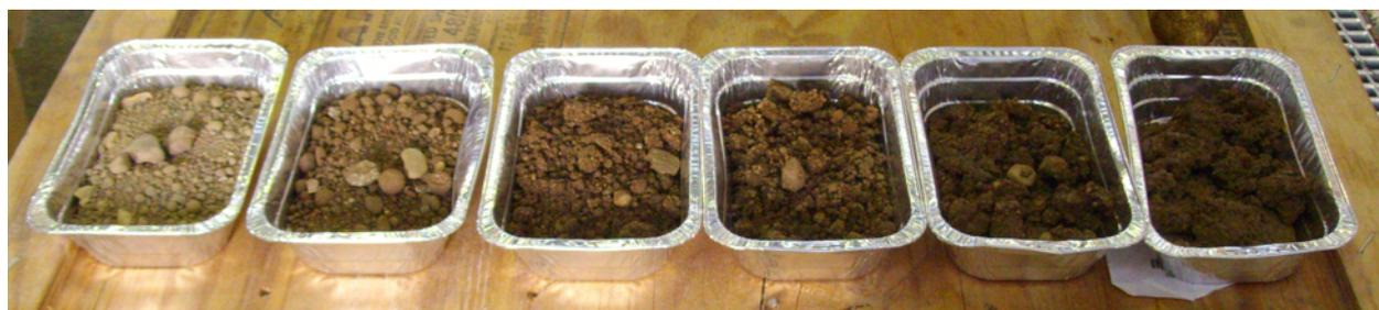
FIGURE 3.28 – Echantillons de sol prélevés lors des mesures à des teneurs en eau de 2, 4, 6, 8, 10 et 12 %
