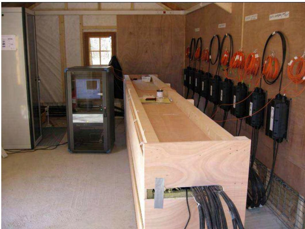
FIGURE 3.16 – Vue de l'intérieur du chalet métrologique : à gauche, l'appareil de mesure, au centre, le four thermostaté et à droite, les boîtiers de soudure des fibres optiques
