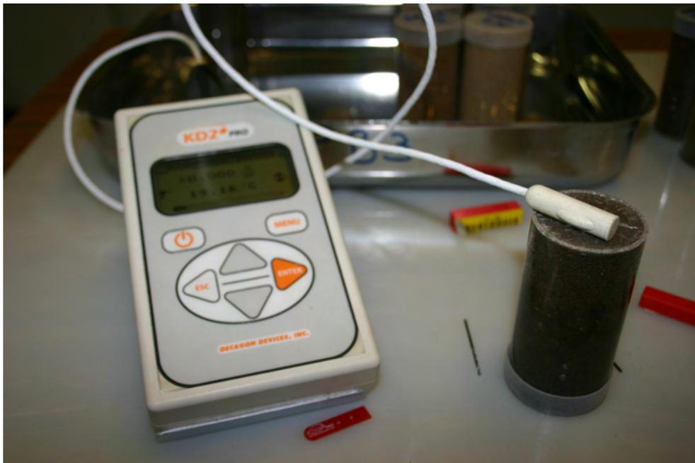
FIGURE 4.3 – Mesure des propriétés thermiques d'un échantillon de sol de la plate-forme expérimentale
