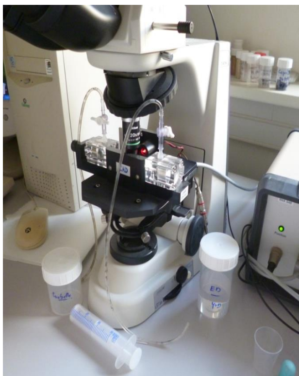
Figure 17 : Système de micro-electrophorèse « Zetaphoremeter IV » (CAD instrumentations, France).
