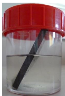
Figure 29 : Coupon de PVC-C incubé dans un pot de prélèvement contenant 30 mL de milieu M63Fensemencé à partir d'une culture de la souche ST111.
