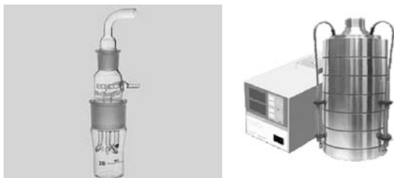
Figure 2. : Photos de deux types de biocollecteurs : (a) un collecteur AGI-30 qui récupère les microorganismes dans une solution liquide ; (b) un collecteur à étages multiples qui sépare les particules en fonction de leur taille et les fait tomber directement sur le support de culture.
