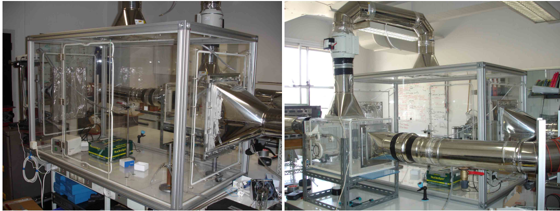
FIGURE 3.7: Cuve en plexiglass dans laquelle ont été générés les divers aérosols
