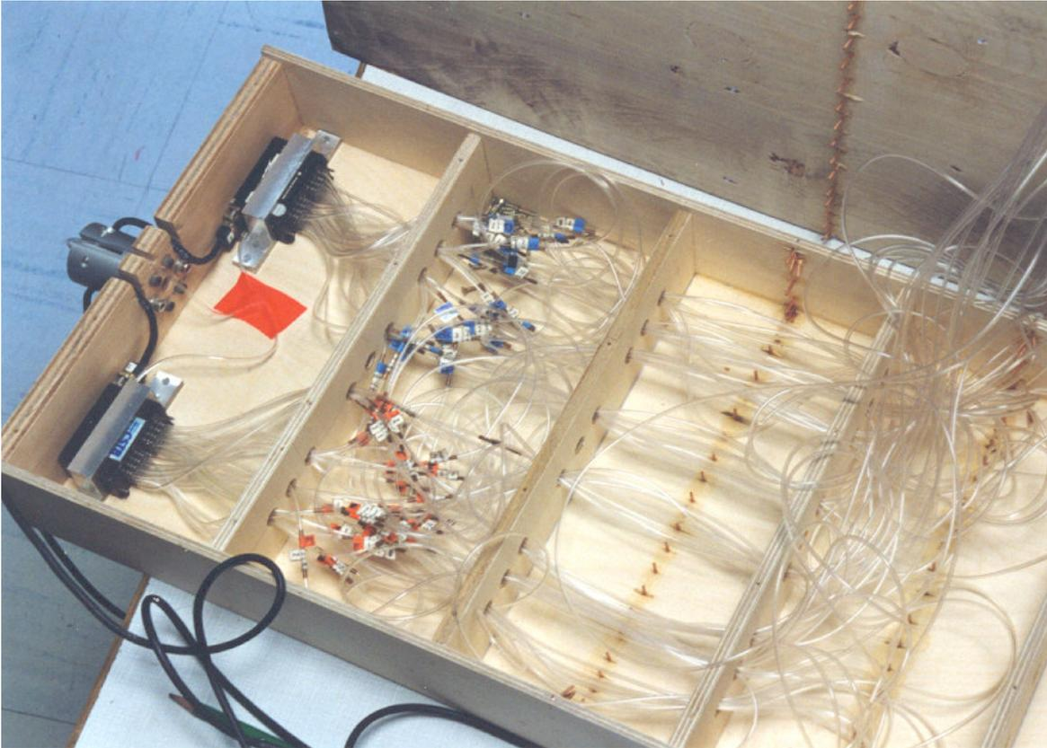
Figure 3.3 – Capteurs de pression à l'intérieur d'une maquette sectionnelle
