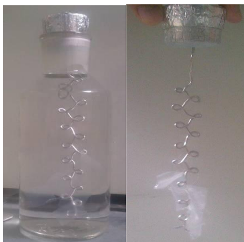
Figure 2-7 : Fiole de vieillissement hydrolytique.
