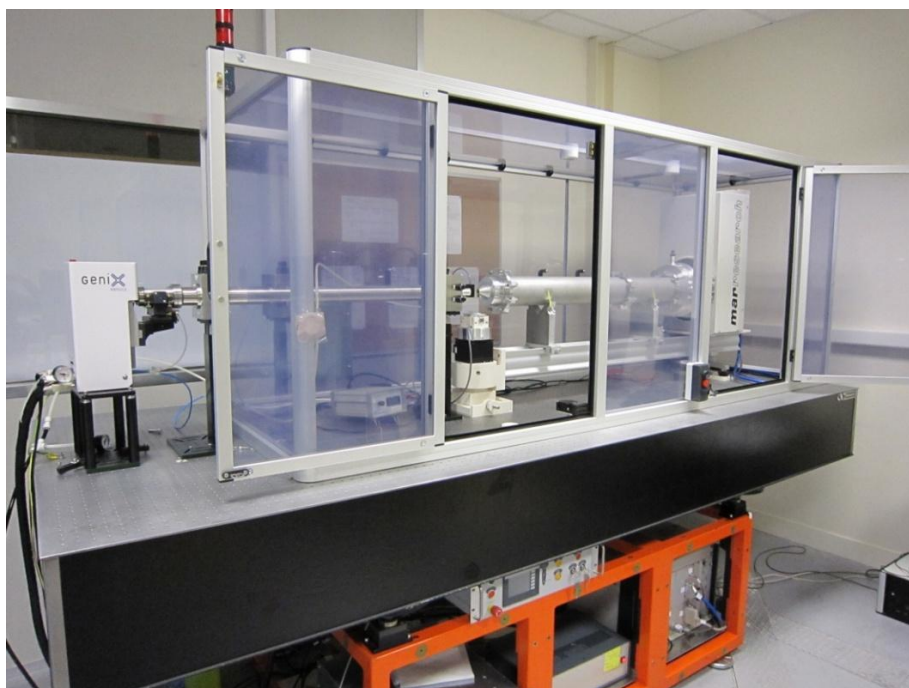
Figure 2-16 : Photographie du montage du SAXS.
