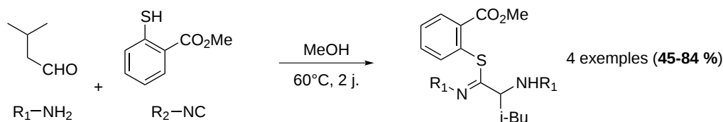
FIGURE 2.29 – Utilisation de thiophénol pour isoler le thioimide dans des réactions de type Ugi-Smiles.
