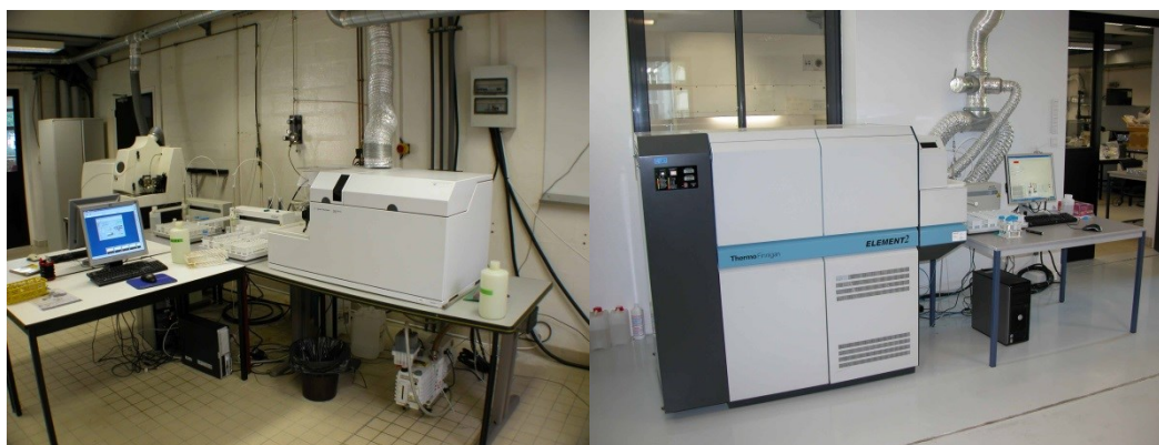
Figure III-16 : Instrumentation pour les analyses multi-élémentaires : Agilent 7500 CX (gauche) et Thermo Scientific Element 2 (droite), à l'ENS de Lyon.
