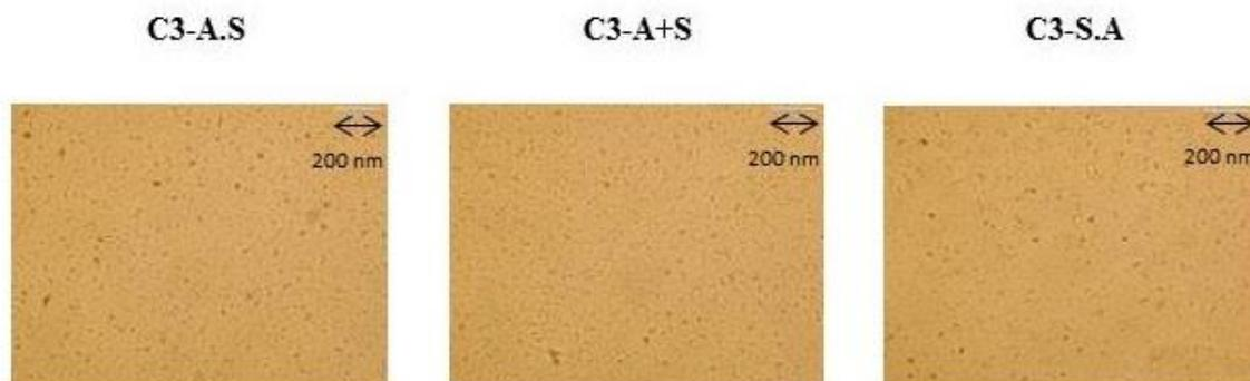
**Figure 93: Image microscopique de mélange nonanal-éthylène glycol en présence de MCM-41 avec chaîne alkyle C<sub>3</sub> et fonction SO<sub>3</sub>H**
