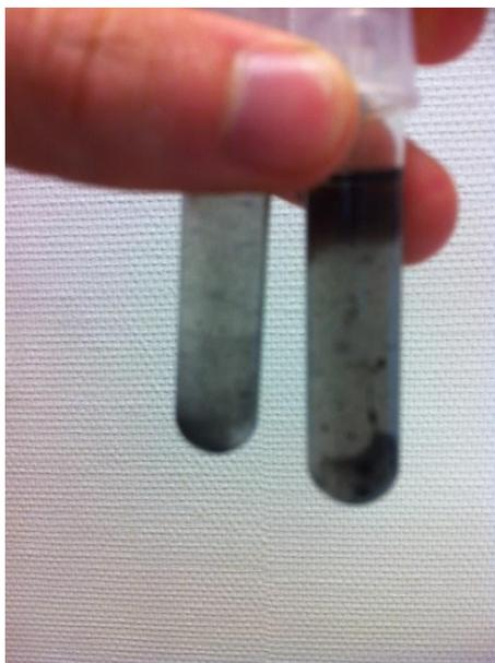
**Figure 95: Photo d'un mélange glycol-décanol en présence de nanoparticules de carbone sulfonée juste après agitation (à gauche NC-TA à droite NC-130)**
