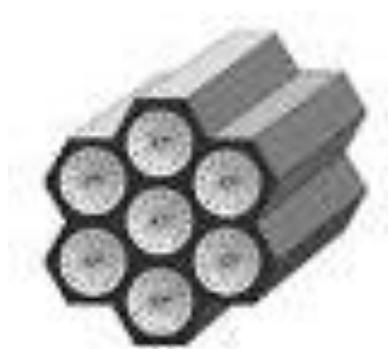
**Figure 74: Schéma représentant la structure d'une MCM-41<sup>[92]</sup>**
